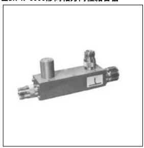
この種の方向性結合器は1000MHz以下の周波数帯のもので結合部分が長いため、ストリップラインを利用し、誘電体を使用して機械的強度を保たせた構造となっています。
